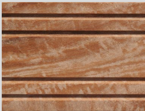
Wechseldrehwuchs, rauhe Stellen
