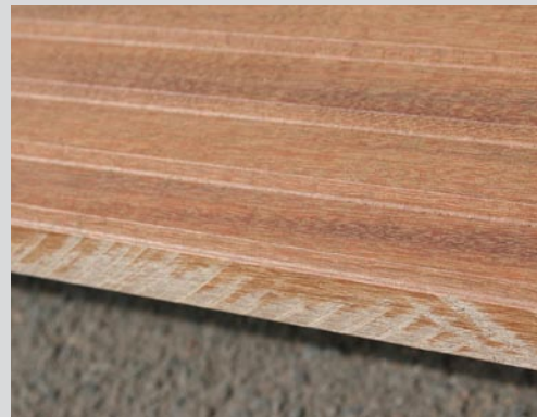
Kanten nicht ausgehobelt
