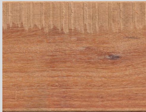
Sägerau, parzellenweise Unterseite
