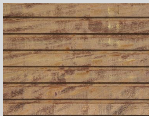
Wechseldrehwuchs, rauhe Stellen
