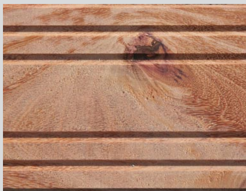
Äste, mit Wechseldrehwuchs
