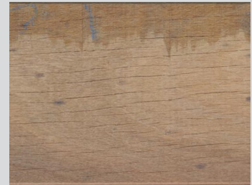
Sägerau, parzellenweise Unterseite
