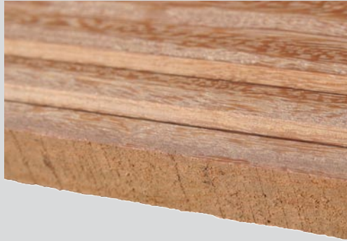
Kanten nicht ausgehobelt
